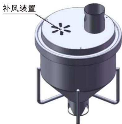
补风装置：在吸料前手动把补风装置打开，可以根据吸料情况调整补风口的大小，方便吸料。吸料装置为悬挂料斗，采用钢丝绳悬挂，由于和砝码重量不一样，可保持垂直上升、下降；另外，补风装置可以调节吸料。
